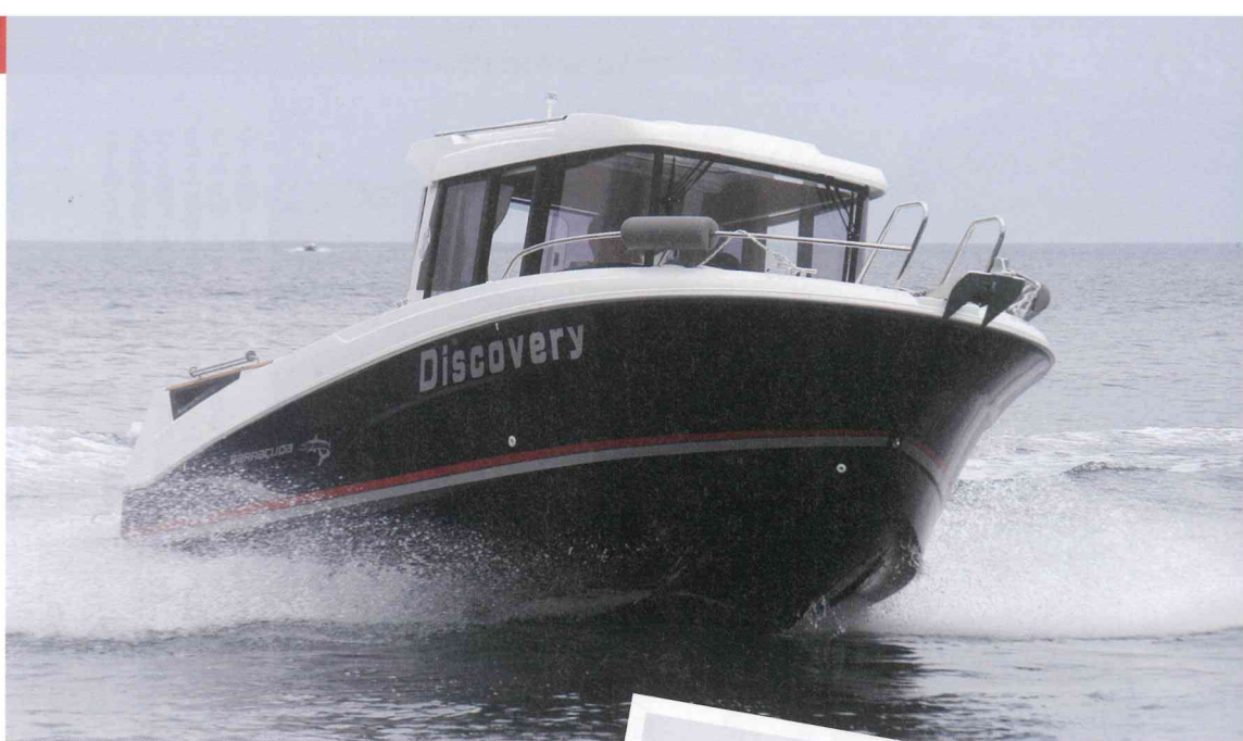
(上) 200馬力船外機搭載。進水式直後の試乗で、搭載されていたGPSプロッターにより計測した最高速は33.4ノット。マリーナスタッフによると、現状ではプロペラピッチが合っていないとのことで、調整後はさらなるスピードが期待できる。重量感のある艇体ながら、クイックな旋回性を見せ、旋回時の姿勢も安定したものであった(右) 穏やかな夏の宮津湾へ。天橋立や伊根の舟屋など、絶景ポイントもほど近く、ゲストを乗せたクルージングメニューにも事欠かないフィールドである
